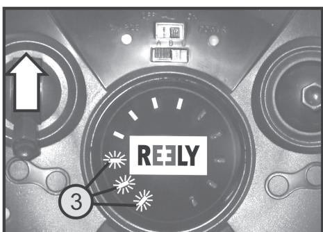
Wenn sich der Steuerknüppel für die Pitch-Funktion wieder in der unteren Stellung befindet, gehen die vier LEDs im oberen Bereich des LED-Anzeigenringes (2) aus und die drei LEDs unten links im LED-Anzeigenring (3) leuchten dauerhaft.
