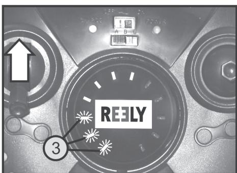
Lorsque le levier de commande pour la fonction de pas se trouve à nouveau en position basse, les quatre DEL en haut de la bague d'affichage DEL (2) s'éteignent et les trois DEL en bas à gauche de la bague d'affichage DEL(3) restent allumées
